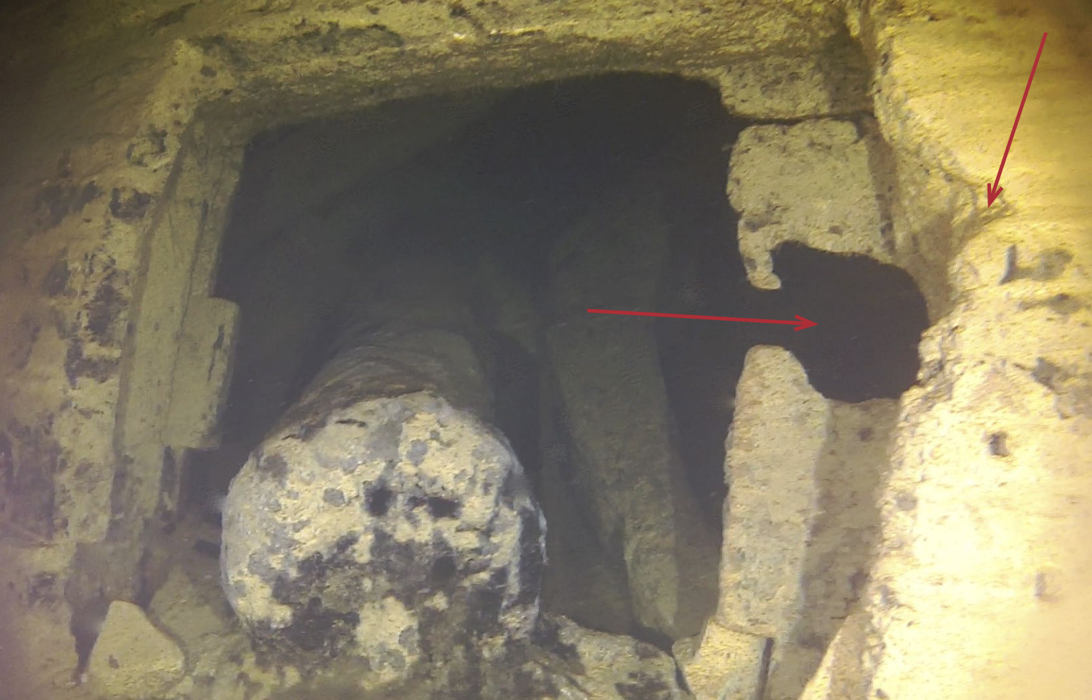
Figur 13. Bilden visar hur en kanonkula flugit rakt igenom första batteridäck, gått igenom denna kanonport och under förloppet skjutit sönder karmen och deformerat bordläggningen på styrbordssidan. Notera även järnkanonen som nästan ramlar ut. Foto: Per Eriksson, Pagi.
