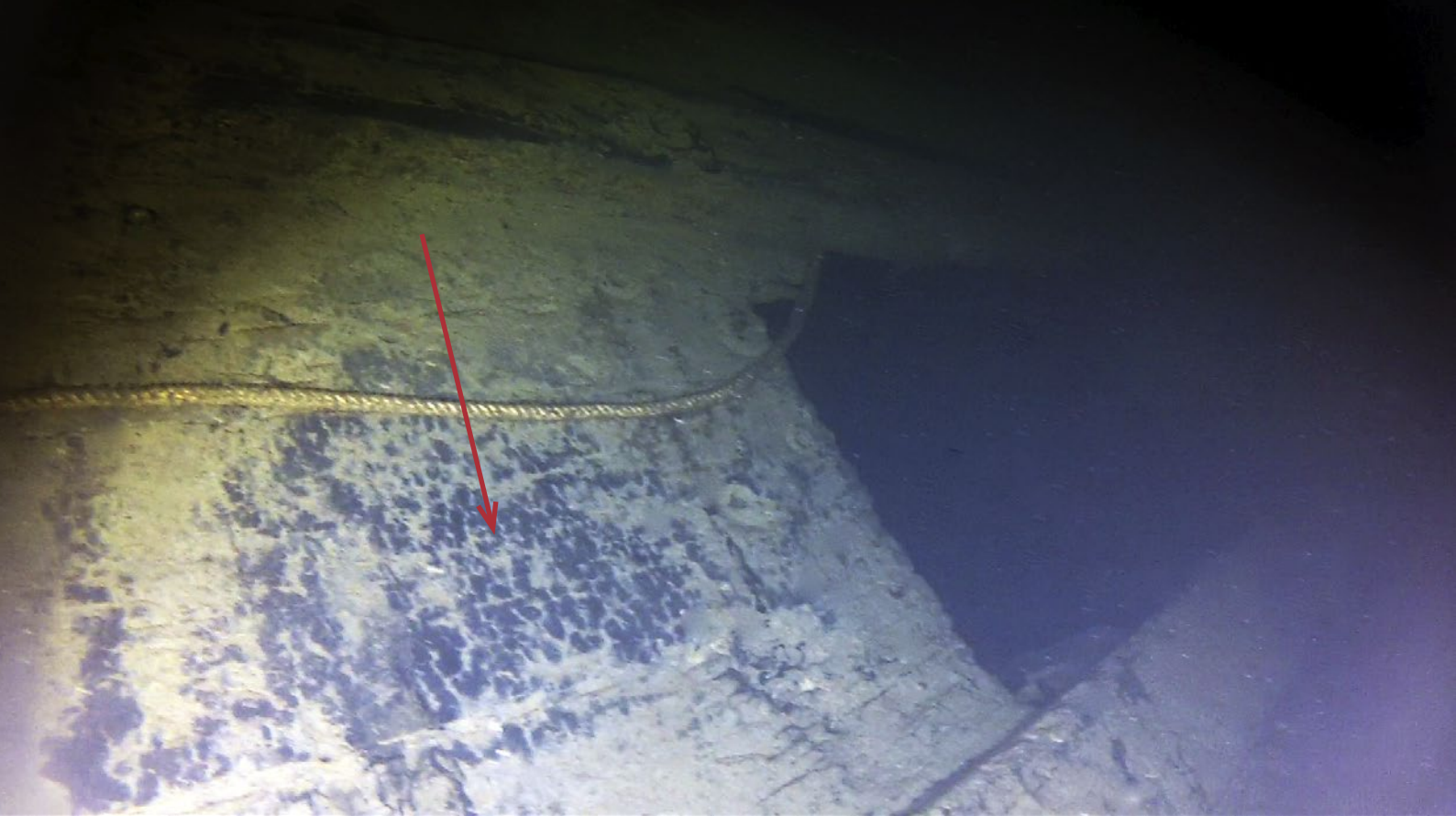
Figur 7. På denna bild kan man tydligt se hur brandskadat skrovet är. Linan som syns tillhör en trål som fastnat på skeppet. Foto: Per Eriksson, Pagi.
