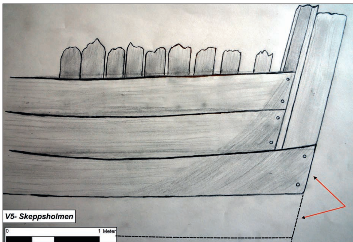
Fig. 24. Den här schematiska skissen visar att de nedre borden (på vraket syns bara det översta ovan botten) löper hela vägen ut till akterstävans slut. Exakt likadan konstruktion kan man bland annat se på Vasa. Skiss: Jim Hansson, Sjöhistoriska museet.
