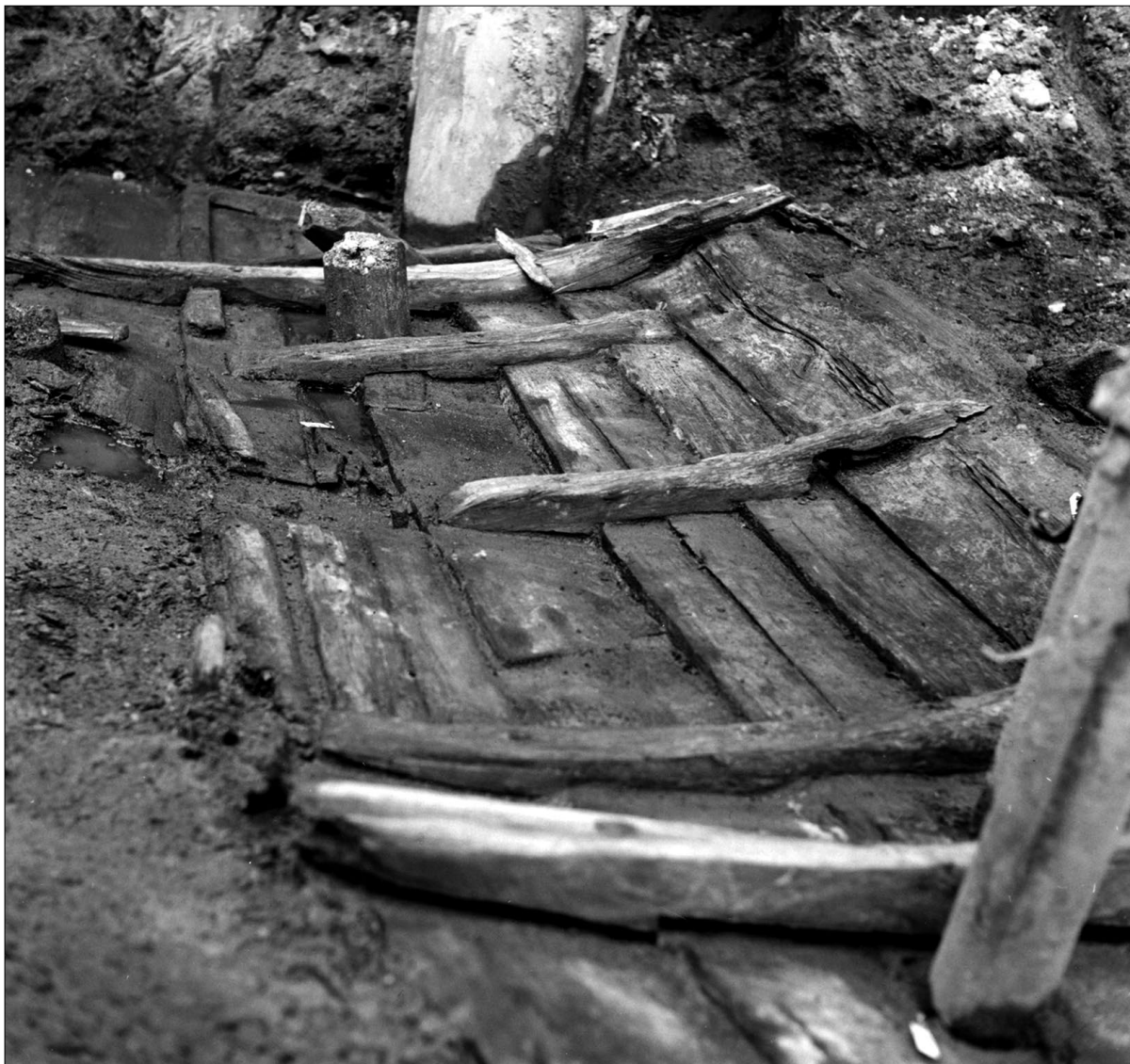
Fig. 22. Svalan 2 Notera stringern, de två längre furuspanten, de olika lagningslapparna samt den snedkapade laskan. © John Hedlund, Stockholms stadsmuseum. S91-0353/9.
